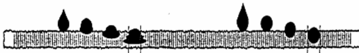
Рис.1. Вид капли водного состава белого пигмента на ткани без праймирования (слева) и с праймированием (справа).
