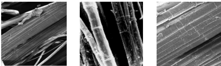
Рис. 5. Микрофотографии ферментативно-модифицированного льна при различном увеличении (электронный микроскоп Tescan VEGA 3 SBH)
