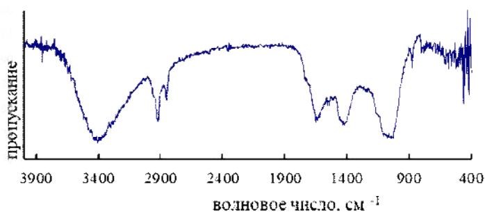
Рис. 3. ИК - спектр ферментативно модифицированного льна (а), экстрагированного диоксаном лигнина (б), препарата пектина срединных пластинок (гемицеллюлозы, полигалактоуриды) (в).
